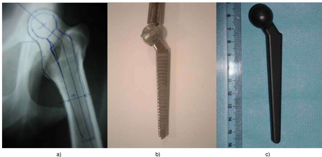
Figura 6.1 – a) Definição da geometria da prótese através do exame de RX b) Raspa fabricada para abertura do canal femoral c) Prótese em PEEK/Carbono fabricada
