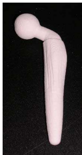
Figura 6.20 - Imagem da réplica do implante obtida por prototipagem rápida
