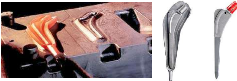
Figura 4.2 – Aspectos do fabrico por forjagem de uma componente femoral de uma prótese da anca. (Fonte: http://www.bbraun.com - Manufacturing practices - hip prosthesis – hot pressing)
