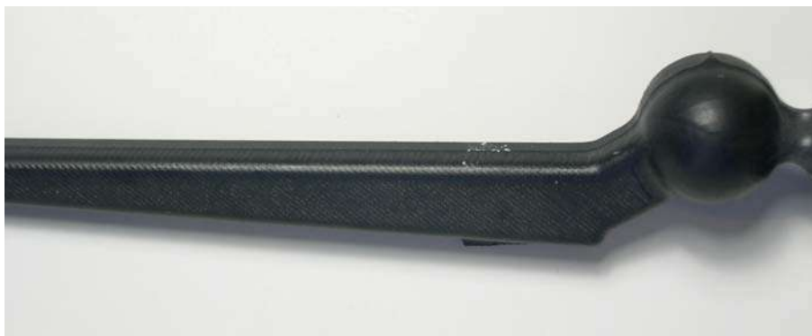
Figura 4.10 – Haste femoral em PEEK-Carbono obtida por fresagem
