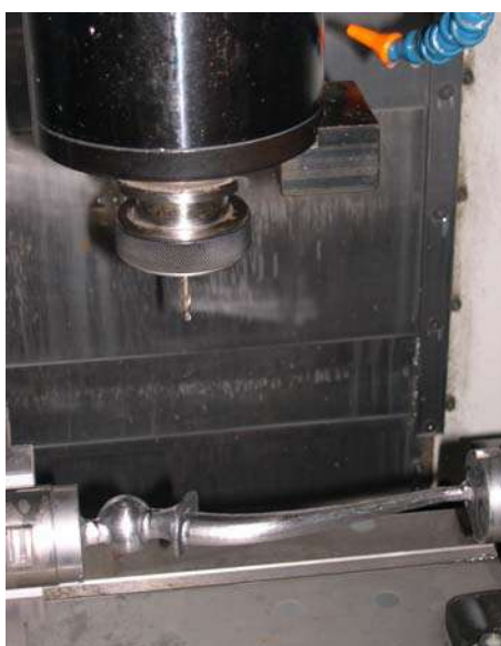
Figura 4.3 – Aspecto geral da maquinagem da componente femoral de uma prótese de anca (fonte: Ramos, 2006)
