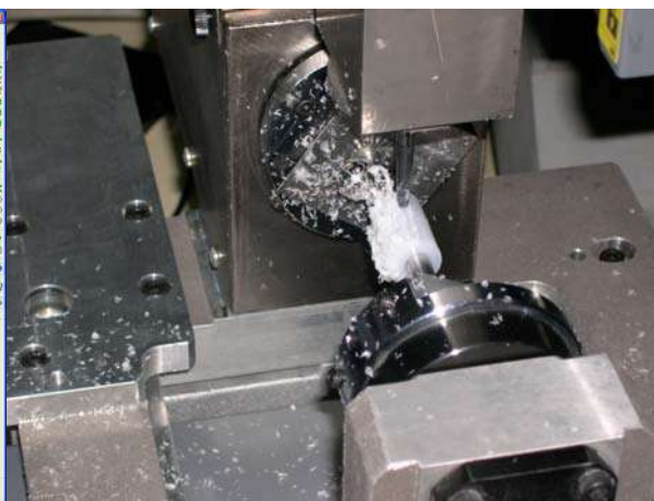
Figura 6.14 - Maquinagem da geometria da prótese
