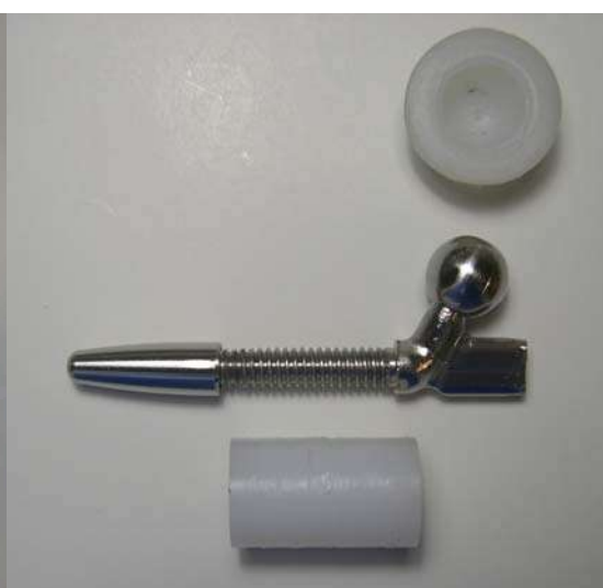
Figura 6.6 – Aspecto da haste femoral com núcleo metálico e revestimento em polietileno e componente acetabular em polietileno.
