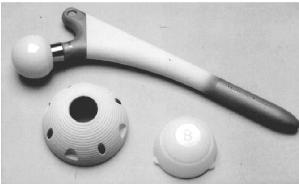
Figura 2.10 – Haste femoral e componente acetabular revestidos com hidroxiapatite (fonte: Radl et al., 2000)
