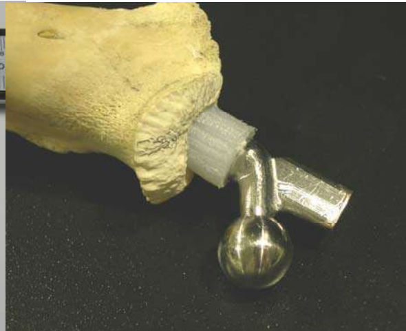
Figura 5.21 – Implantação da prótese no osso cadavérico.
