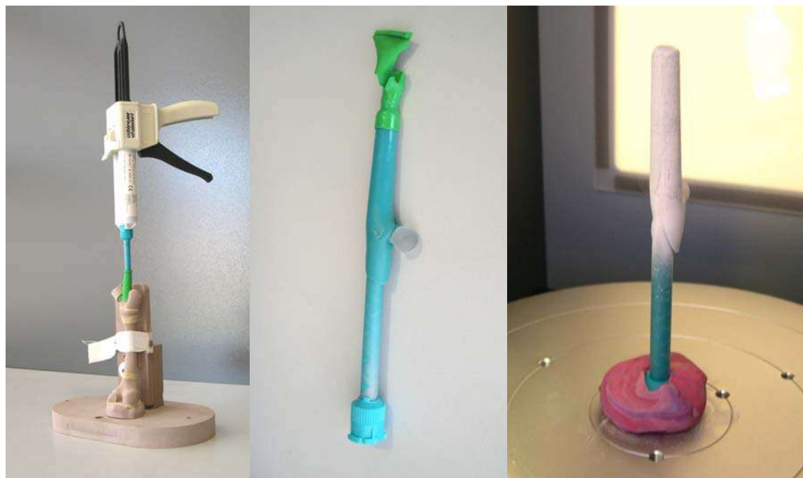
a) Injecção de polivinilsiloxano para a aquisição de forma
