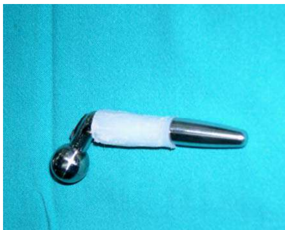
Figura 6.15 - Aspecto geral da prótese depois de maquinada
